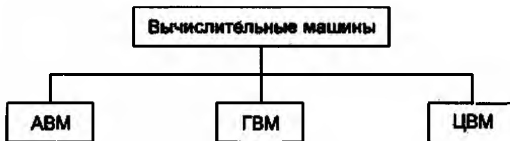
Рисунок 3.1. Классификация вычислительных машин по принципу действия
