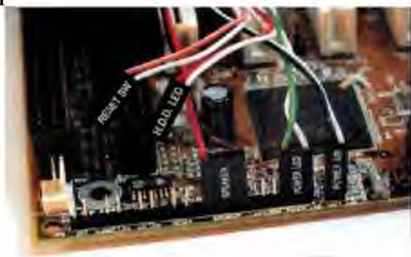
Подсоединение кабелей от передней панели ПК к материнской плате.
