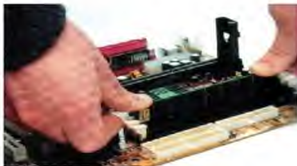
Установка памяти DIMM в слот на материнской плате
